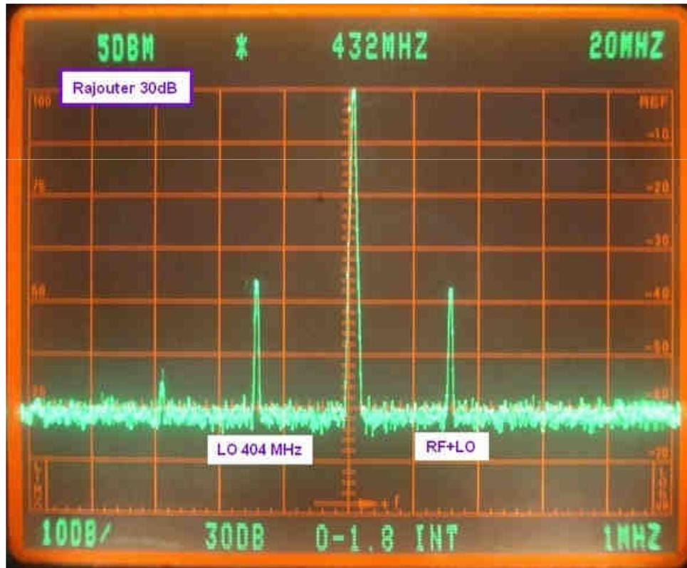
Meilleure isolation des fréquences adjacentes, obtenue sur la version N-2 (mélangeur IM06)
